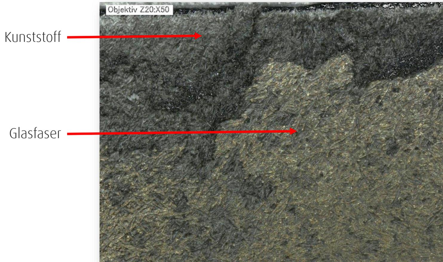
Mikroskopaufnahme des Probekörpers nach der Zugprüfung (Mischbruch)
