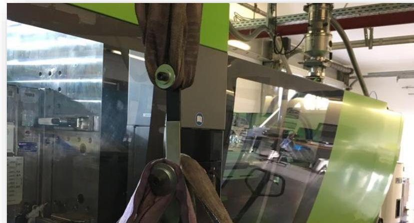
Zugscherprobe als Verbindung
